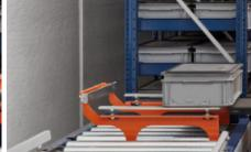
I trasportatori a rulli si trovano nella testata del magazzino per prelevare o depositare i contenitori nel trasloelevatore.
