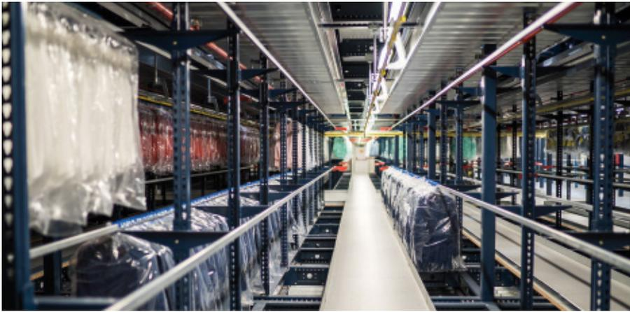
I tubi utilizzati per appendere gli abiti alle scaffalature sono ubicati a un'altezza ottimale da un punto di vista ergonomico e, benché abbiano supporti ogni 2,2 m, le grucce scivolano e si raggruppano per referenze senza produrre nessun tipo di interferenza.
