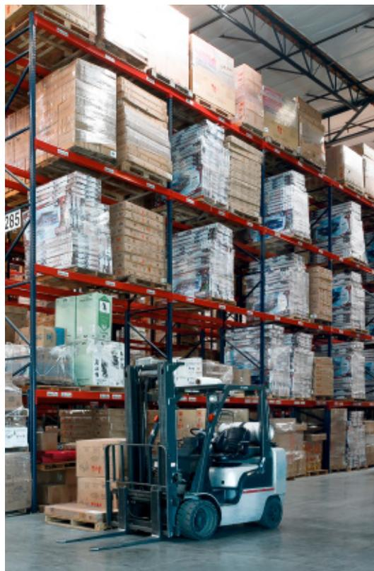
La California è abbastanza nota per l'elevata attività sismica, pertanto, le scaffalature portapallet imbullonate di Interlake Mecalux sono state progettate e rinforzate proprio per assorbire la forza generata da eventuali movimenti tellurici
