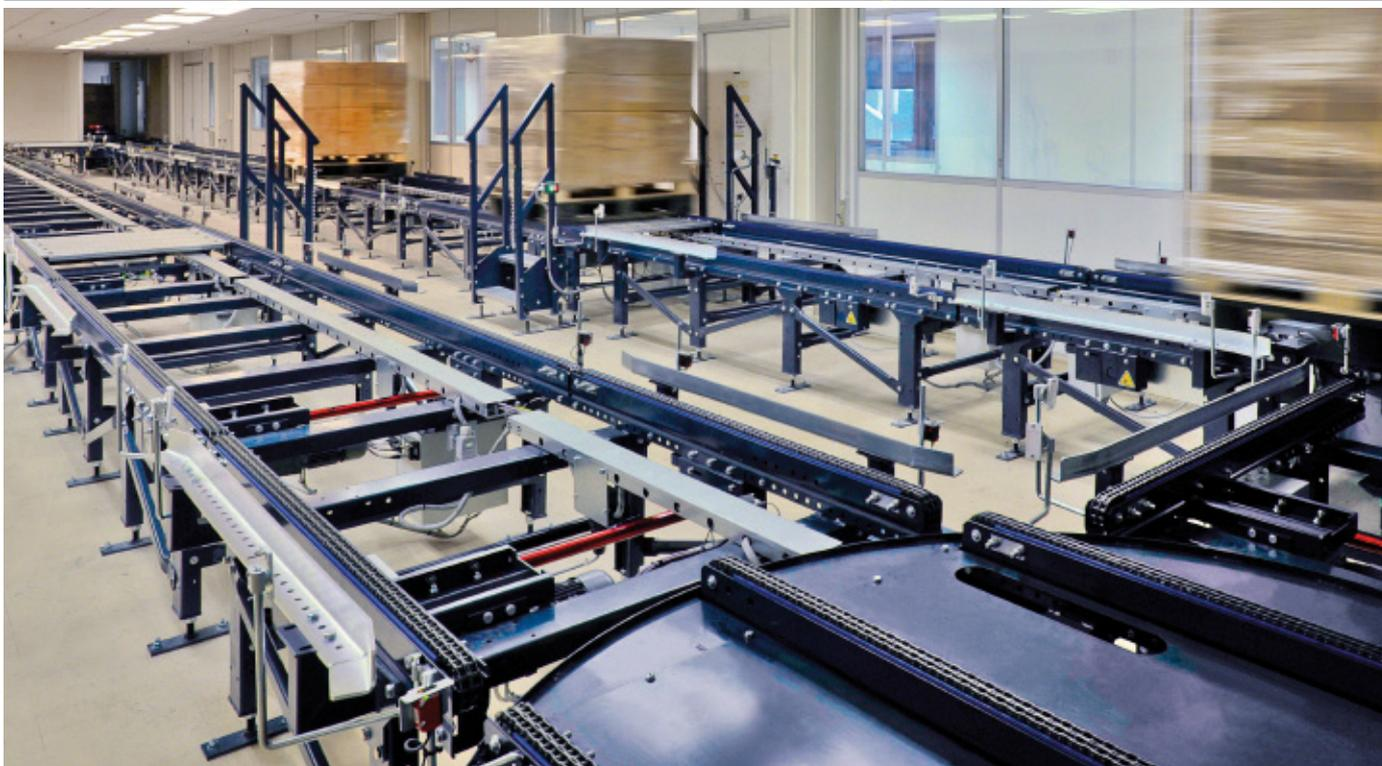
La marca di tè francese Dammann Frères ha un nuovo magazzino attrezzato con scaffalature portapallet e un circuito di trasportatori automatici in comunicazione con il centro produttivo. È un sistema di trasporto molto efficace che garantisce un flusso costante di merce e riduce al minimo le interferenze degli altri cicli operativi.
