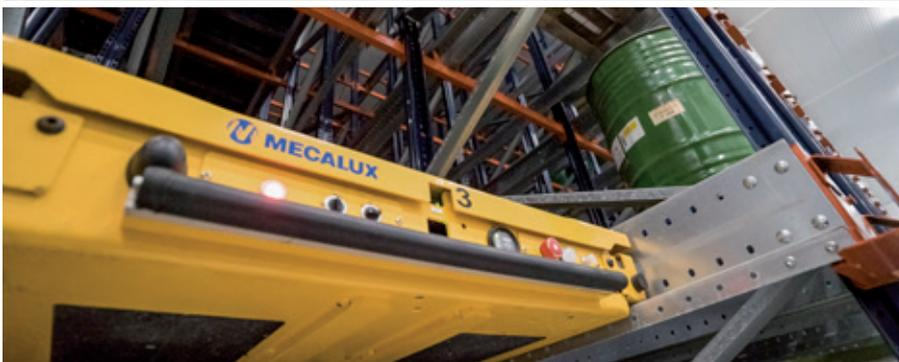
Serfrial, azienda appartenente all'operatore logistico Grupo Fuentes, ha ristrutturato due celle frigorifere situate a Las Torres de Cotillas (Murcia). L'azienda ha fornito scaffalature a stoccaggio intensivo assistite dal sistema Pallet Shuttle semiautomatico che offrono una capacità di stoccaggio complessiva di 26.880 posti pallet.
