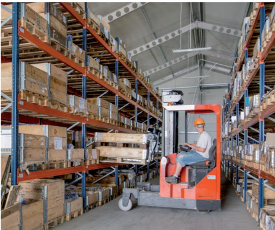
**Il magazzino per profilati metallici di MetalERG è composto da scaffalature portapallet e cantilever. I due sistemi sono in grado di stoccare prodotti di dimensioni e caratteristiche diverse e offrono accesso diretto alla merce, garantendo così più efficienza nelle attività di stoccaggio e di preparazione degli ordini.**
