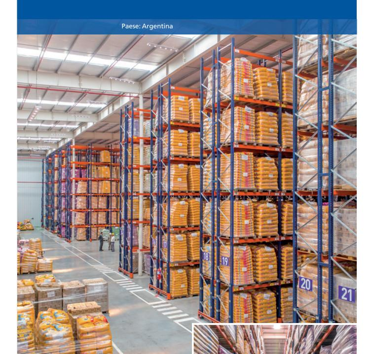
Mecalux ha fornito il sistema di scaffalature portapallet nei due nuovi magazzini che Qbox ha costruito nel proprio centro logistico in Argentina. Complessivamente, la capacità di stoccaggio ottenuta è superiore a 29.500 posti pallet. Le scaffalature sono in grado di alloggiare prodotti di varie misure e caratteristiche, inoltre, sono molto adatte per effettuare il picking direttamente dai pallet.
