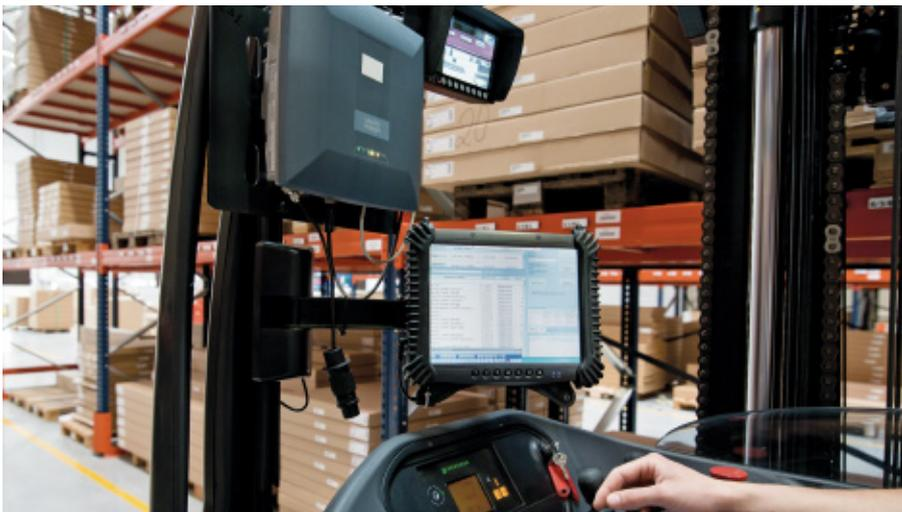
Per favorire la movimentazione dei pallet ed evitare di urtare le scaffalature, nella parte superiore delle forche dei carrelli elevatori è incorporata una telecamera e le immagini riprese sono visualizzate sullo schermo della cabina dell'operatore
