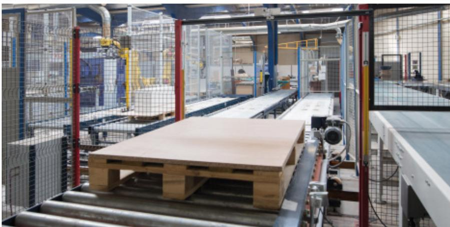
Mecalux ha installato un circuito all'avanguardia di trasportatori nel centro produttivo di Euréquip, azienda francese produttrice di mobili. Il circuito ha il compito di movimentare la merce nelle varie fasi di lavorazione che trasformano i pannelli di legno utilizzati per la successiva produzione dei mobili. Questo sistema di trasporto velocizza il trasferimento della merce verso le varie postazioni coinvolte nel ciclo operativo.
