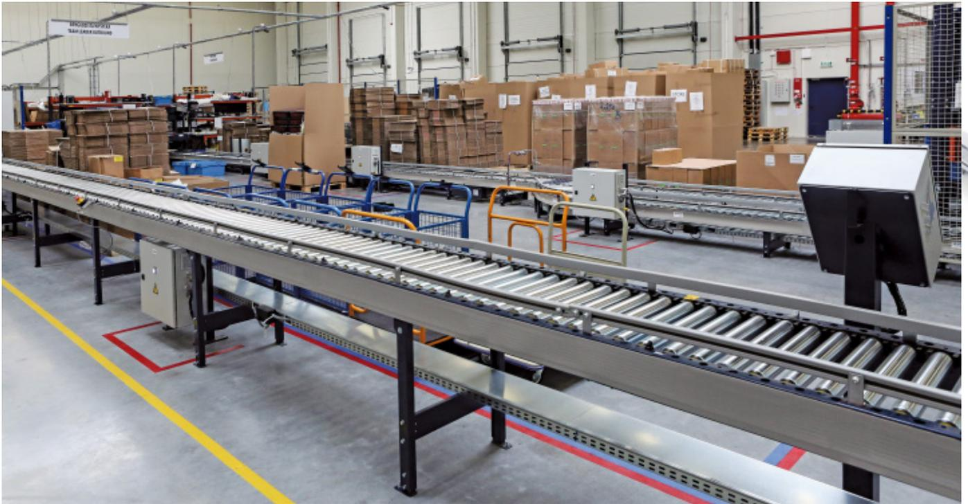
Le casse arrivano alle postazioni di picking tramite un circuito di trasportatori che è lungo oltre 38 m
