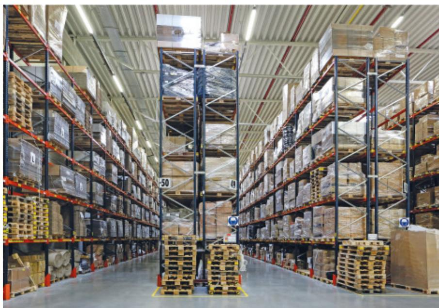
**Le scaffalature, con una capacità di stoccaggio di oltre 5.500 pallet da 800 x 1.200 x 1.400 mm e un peso massimo di 920 kg, possiede sei livelli di carico**
