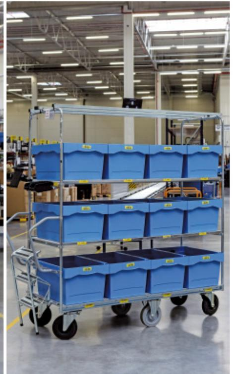
tallica che protegge le estremità e quattro ruote, mentre i commissionatori, in grado di trasportare fino a 12 casse da 336 x 518 x 302,5 mm, sono composti da tre ripiani in rete, sei ruote e una scala posizionata in una delle estremità che agevola l'operatore durante le operazioni di picking in altezza.
