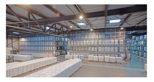
funzionano con il sistema di gestione LIFO, mediante il quale le entrate e le uscite avvengono dallo stesso lato. I blocchi sono stati divisi tenendo conto dell'indice di rotazione dei prodotti:
