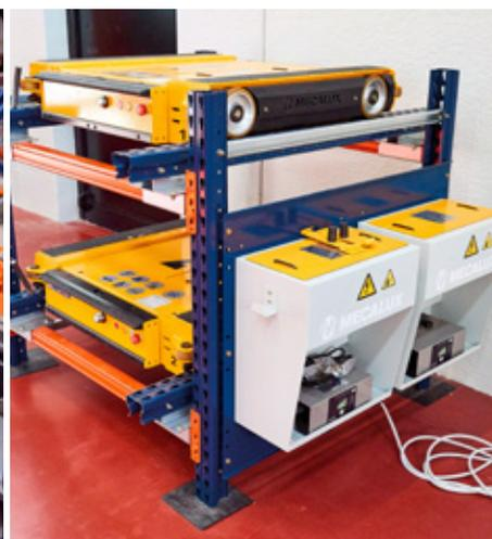
tinuano a lavorare. Le batterie si estraggono dalle navette e si collegano a incastro nella stazione di ricarica che si trova a lato della baia. È stato fornito anche un cavo indipendente che consente di caricare la navetta direttamente senza dovere estrarre la batteria.
