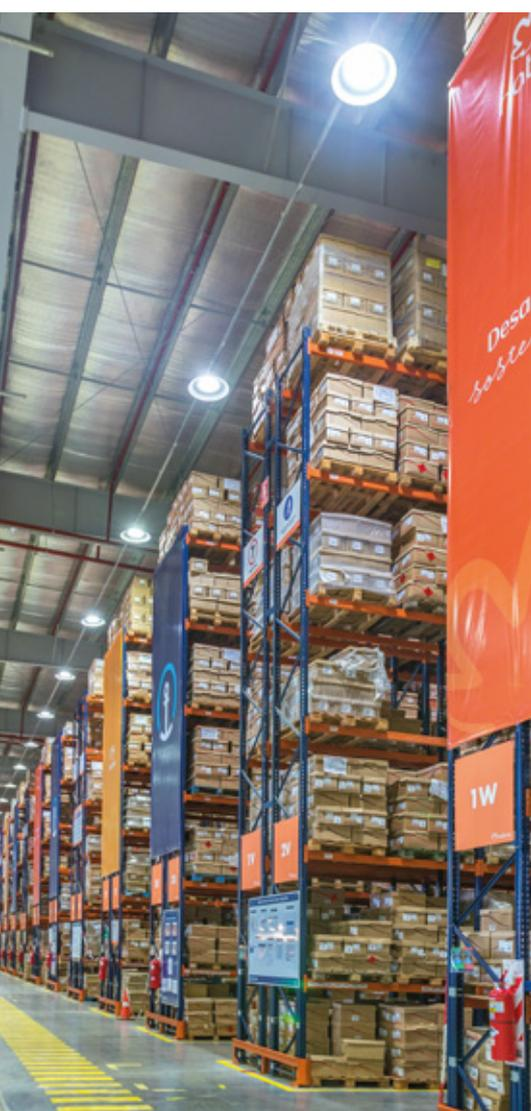
Per una maggiore sicurezza, sono stati protetti i montanti di tutte le scaffalature, nonché le spalle che coincidono con le estremità e con la corsia interna. Tutto ciò,
