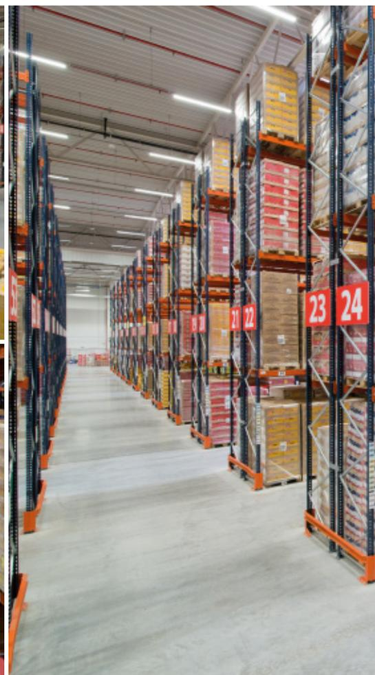
Per un maggior livello di sicurezza, i montanti di tutte le scaffalature sono stati protetti, così come le spalle allo scopo di ammortizzare gli impatti provocati dai mezzi di sollevamento durante la movimentazione delle unità di carico.
