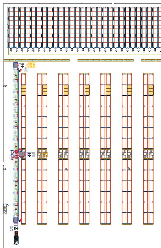
La prima di esse, a metà del circuito, coincide con il blocco di scaffalature portapallet, dove sono diretti i pallet di scorta dei prodotti a bassa rotazione. È stato inoltre adibito un sottopasso, che attraversa trasversalmente tutte le scaffalature e facilita il flusso dei movimenti degli operatori per depositare i prodotti nelle rispettive ubicazioni.
