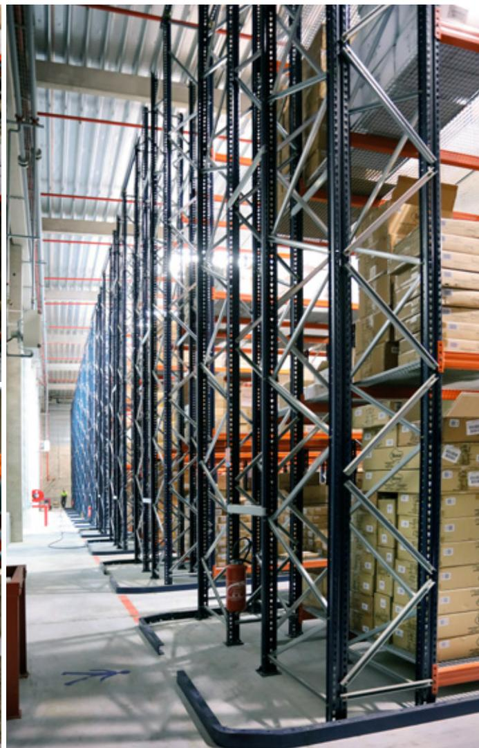
I ripiani continui in grigliato pressato consentono di aumentare la capacità di stoccaggio e permettono all'operatore di poggarsi sopra di esse per raggiungere le scatole che si trovano in seconda e terza posizione
