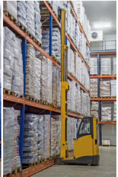
Il centro logistico di Bajofrío, capace di stoccare 6.000 pallet, è stato diviso in due celle frigorifere identiche da 1.000 m<sup>2</sup>, mantenute a una temperatura di -25 °C
