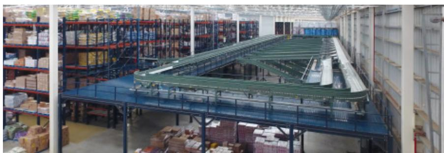
**4. Magazzino Pallet Shuttle:** sono stati installati due livelli di scaffalature ad accumulo con il sistema Pallet Shuttle semiautomatico su un soppalco situato davanti alle baie di carico. La capacità è pari a 512 pallet di prodotti ad alta rotazione (tipo A).
