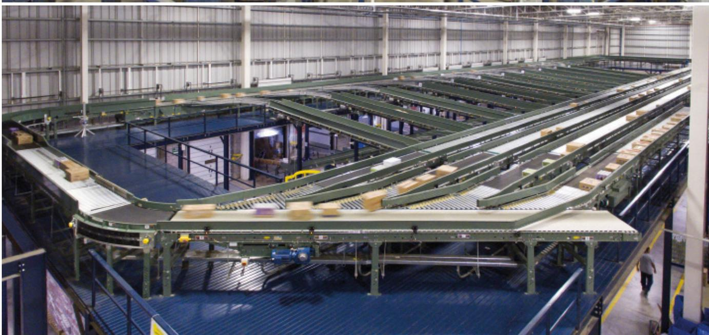
Il centro logistico di DECASA nello stato di Veracruz è costituito da una grande varietà di soluzioni: magazzino automatico autoportante, sistema semiautomatico Pallet Shuttle, scaffalature a grande altezza per il picking da pallet e contenitori, sorter di smistamento ecc. L'impianto, con una capacità di oltre 36.500 posti pallet, è inoltre dotato dell'SGM Easy WMS di Mecalux e del programma di controllo Galileo.
