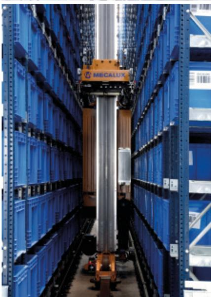
Mecalux, fornitore abituale di Renfe, ha progettato un magazzino adatto a tutti i centri di manutenzione dell'impresa ferroviaria. La soluzione è una combinazione tra un magazzino miniload per contenitori, un magazzino automatico per pallet e un magazzino con scaffalature cantilever destinato al materiale voluminoso. L'intero sistema è controllato dal software di gestione del magazzino Easy WMS di Mecalux.
