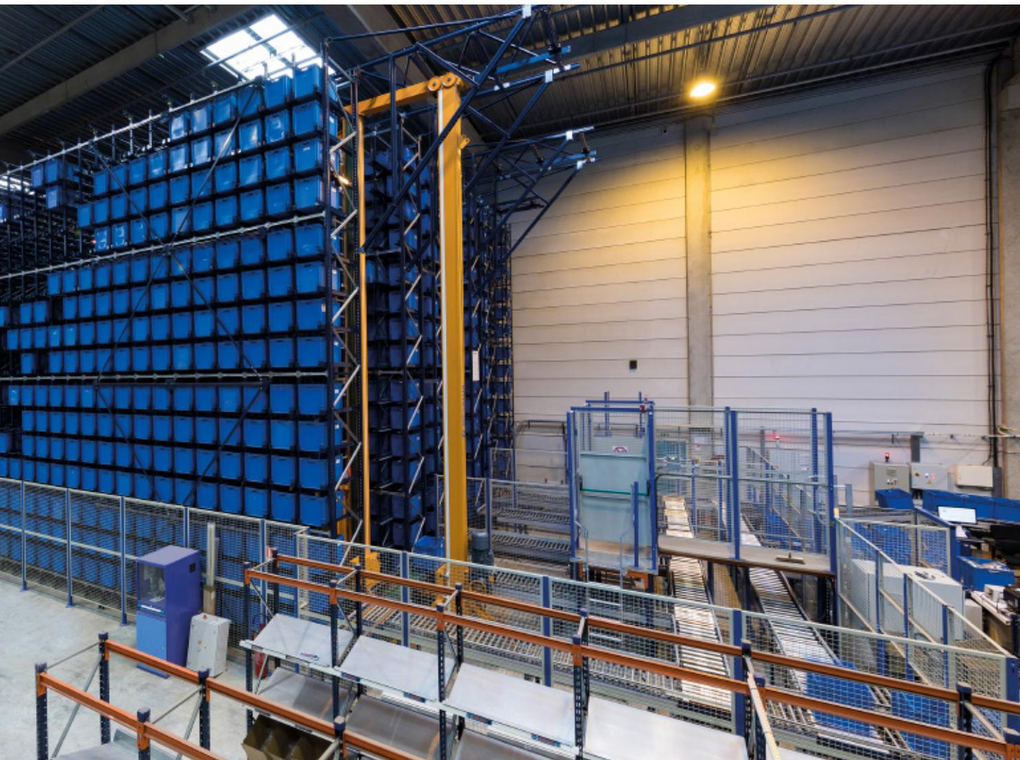
In ogni corsia circola un trasloelevatore miniload di tipo bicolonna che si occupa delle entrate e uscite della merce. Queste macchine lavorano a una velocità di traslazione di 250 m/min e 90 m/min in elevazione.
