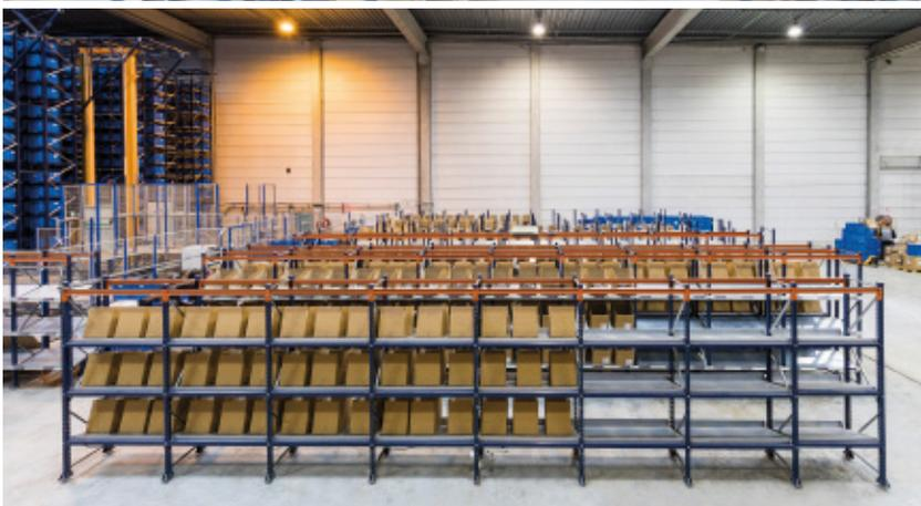
Il centro di distribuzione di Groupe Rand a Longueil Sainte Marie (Francia) è caratterizzato dalla flessibilità e l'agilità nel preparare gli ordini. L'impianto fornito da Mecalux è formato da un magazzino miniload con una capacità di stoccaggio superiore ai 15.300 contenitori, scaffalature portapallet e scaffalature con dispositivi *put-to-light* per classificare la merce in vari ordini allo stesso tempo, senza gli eventuali errori derivati dalla gestione manuale.
