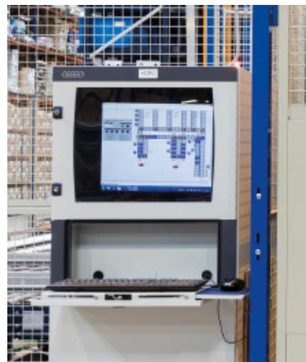
Il modulo di controllo Galileo si occupa di dirigere le movimentazioni che devono eseguire le attrezzature di movimentazione dell'impianto, come i trasloelevatori miniload e le rulliere
