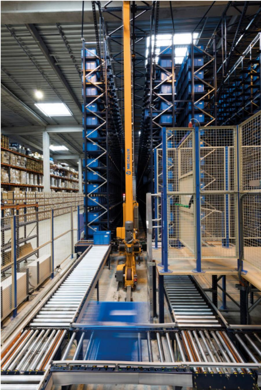
Nella parte frontale del magazzino automatico si trovano tre postazioni di picking dove si preparano gli ordini in base al principio "prodotto verso uomo", vale a dire i trasloelevatori forniscono la merce direttamente agli operatori. A questo scopo, posizionano i contenitori sulle rulliere, che li trasferiscono in modo automatico alle postazioni di picking.
