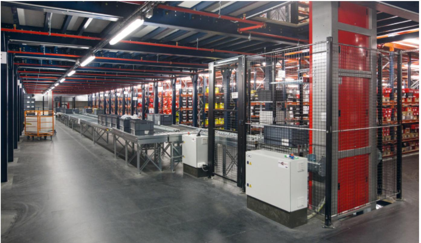
L'elevatore verticale si occupa di trasferire automaticamente i contenitori fino al livello assegnato
