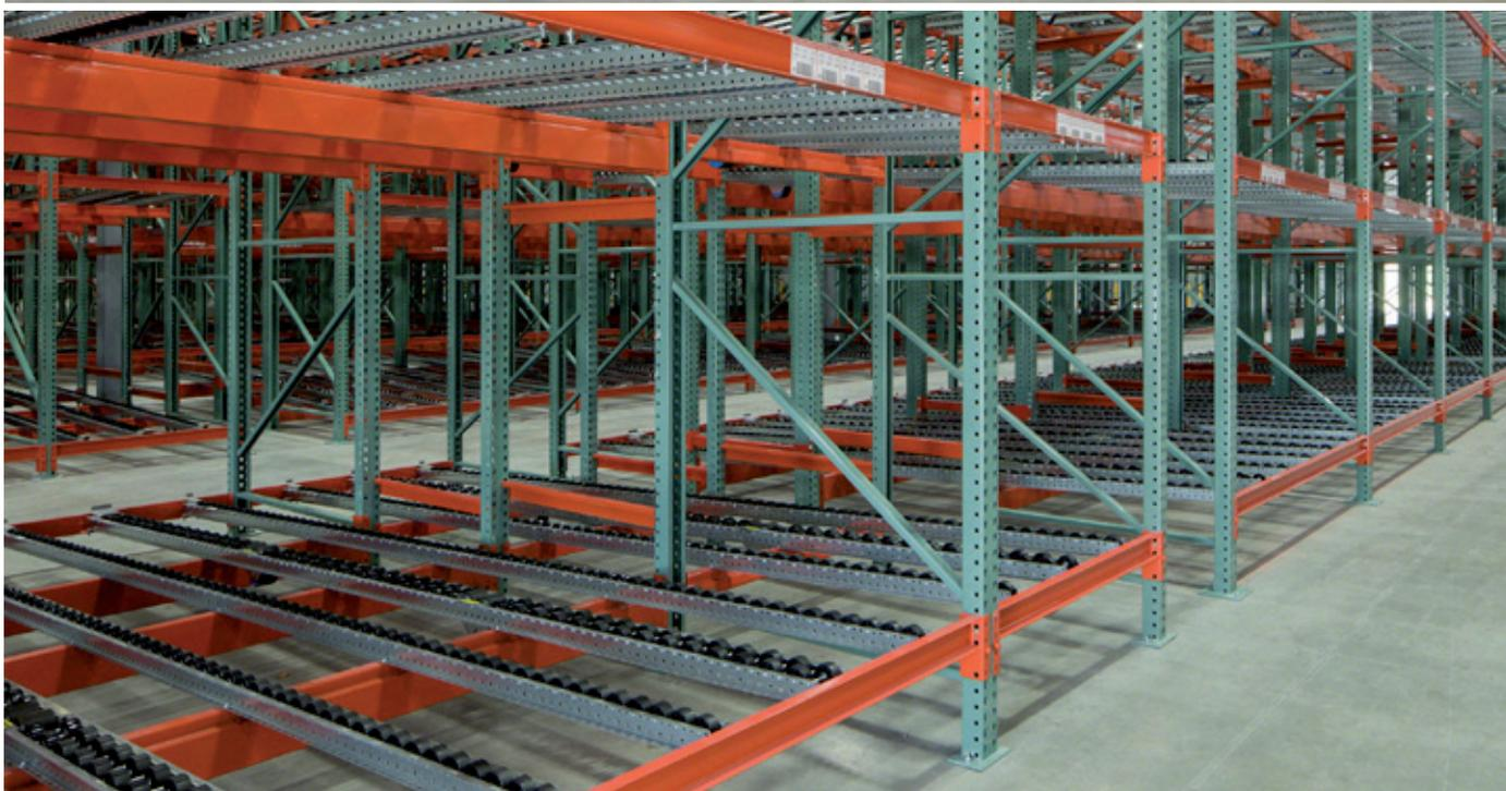
Interlake Mecalux ha attrezzato il magazzino di Pet Supermarket in Florida (Stati Uniti) con scaffalature a gravità che offrono una capacità di 2.048 posti pallet. Il principale vantaggio di questa soluzione è che garantisce una perfetta rotazione dei prodotti e al contempo velocizza la gestione delle 3.000 referenze gestite dall'azienda.
